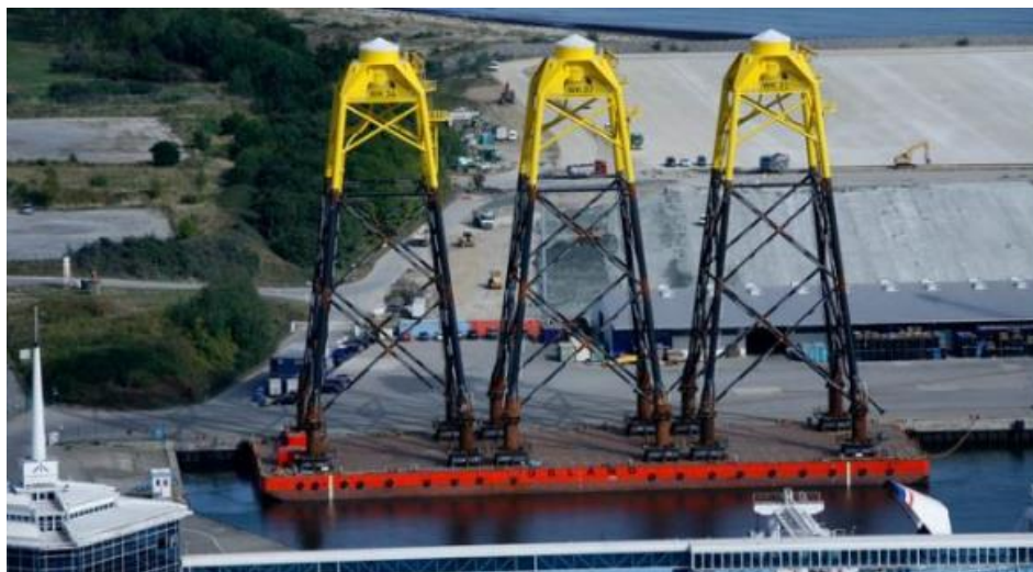
Figura 14 - Típica fundação jacket ( https://www.iberdrola.com ).
